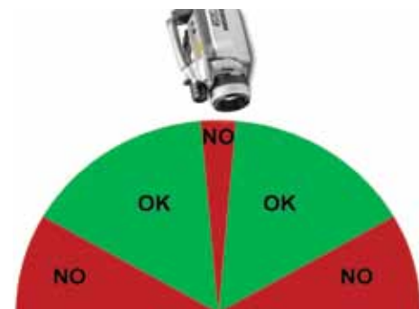
Valeurs recommandées (en vert) et à éviter (en rouge) pour l'angle d'observation avec une caméra thermique.
